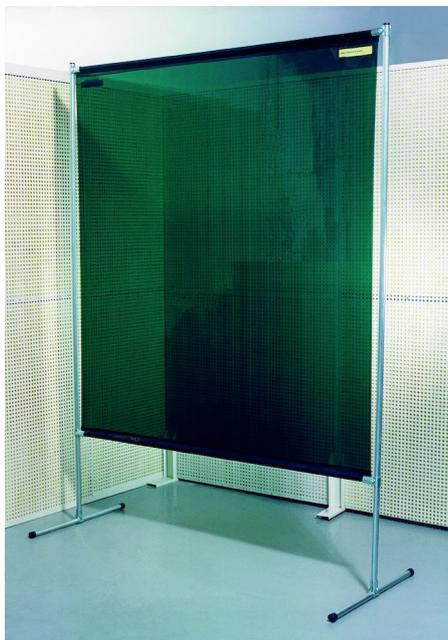
Легко передвигаемые защитные экраны для сварки, шлифовки, обточки, фрезерования и т.д., идеально подходят для защиты временных или постоянных рабочих мест. Рама изготавливается из оцинкованной трубы, шторы - из самозатухающего ПВХ материала в соответствии со стандартом EN 1598 для сварки. Общие размеры ШxВ = 2000 x 2000 мм (H шторы = 1700 мм). Вес 7.5 кг.
