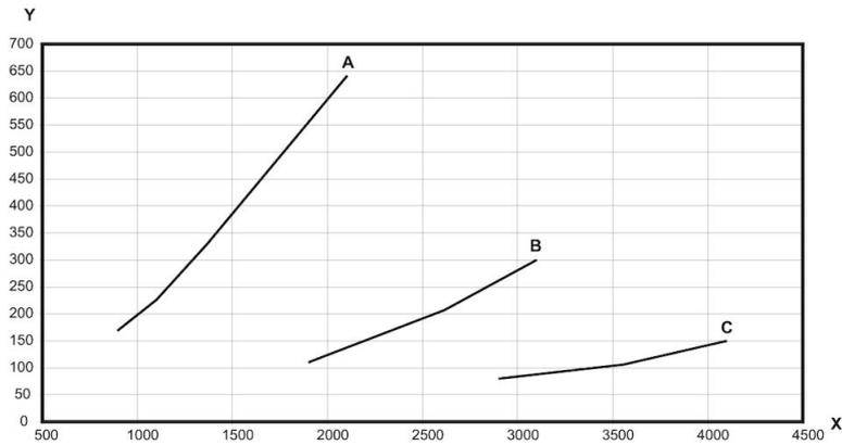
X: воздушный поток, м³ / ч, Y: статическое давление (Па), A = 900, B = 1350, C = 2000
