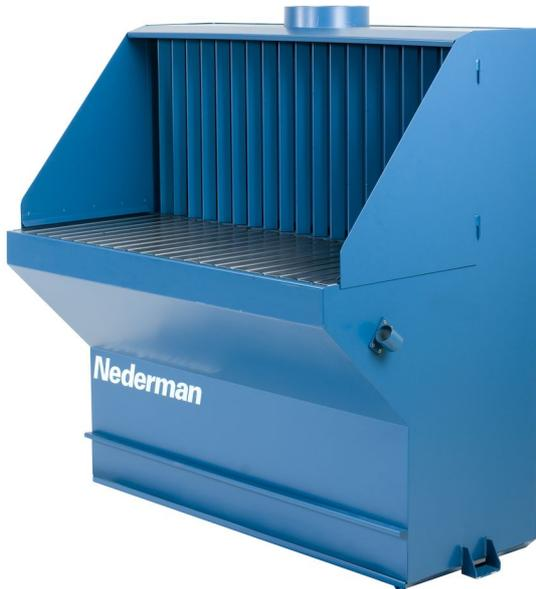
Промышленный стол для сварки и обточки с удалением дыма, пыли и продуктов сварки и шлифовки. При надлежащем заземлении, он также может использоваться во взрывоопасной среде. Стол не предназначен для резки. Сбоку стола предусмотрена подвеска сварочной горелки, когда она не используется. Внизу рабочей зоны установлен пылесборник, в котором собирается пыль.
