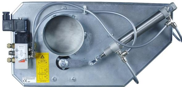
Клапаны TAV 100 и TAV 150 в основном используются в качестве запорных клапанов в основных ветках системы трубопроводов. Поскольку клапаны можно открывать и закрывать автоматически, вакуум всегда концентрируется только на соединениях, точках отбора или машинах которые в данный момент находятся в эксплуатации. Это увеличивает мощность всасывания, снижает эксплуатационные расходы и минимизирует размеры вакуумной установки.
