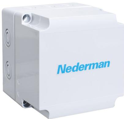
Для пуска / остановки центрального вентилятора совместно с определенным числом моторизованных заслонок (вентиляторы большей мощности могут удаленно управляться с помощью стартера или инвертера вентилятора). В комплект выключателя вентилятора входит защита двигателя. Класс защиты IP66. Обмотка 24В переменного тока, от блока управления или трансформатора.
