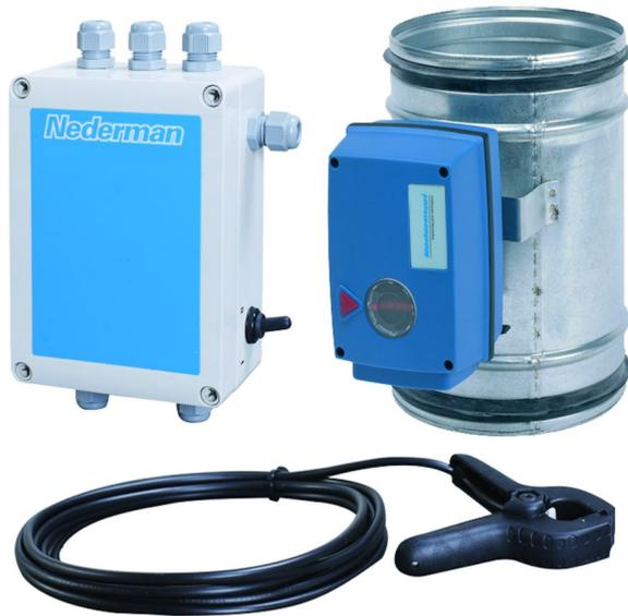
Заслонка состоит из выключателя вентилятора и блока управления, который может управляться контактором или выключателем. Блок управления состоит из трансформатора на 30 ВА для комплекта освещения в вытяжном рукаве, таймера задержки выключения вентилятора в интервале 0-5 минут, двух отдельных соединений для сенсорных зажимов.
