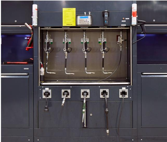
Система контроля смазки NMS для полного контроля жидкостями точно контролирует и подает правильное количество масел и жидкостей на каждое транспортное средство без ручного управления или нарезания резьбы. Он также информирует поставщиков, когда пришло время пополнить танки. Это конец утечки, потери и ненужных остановок.
