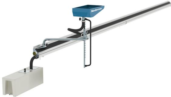
Рельс монтируется с небольшим уклоном вдоль рабочей ямы, что делает отработанное масло автоматически текущим до конца рельса, где оно временно хранится в баке емкостью 80 литров. Затем отработанное масло может быть слито или закачено в центральный резервуар для отработанного масла.
